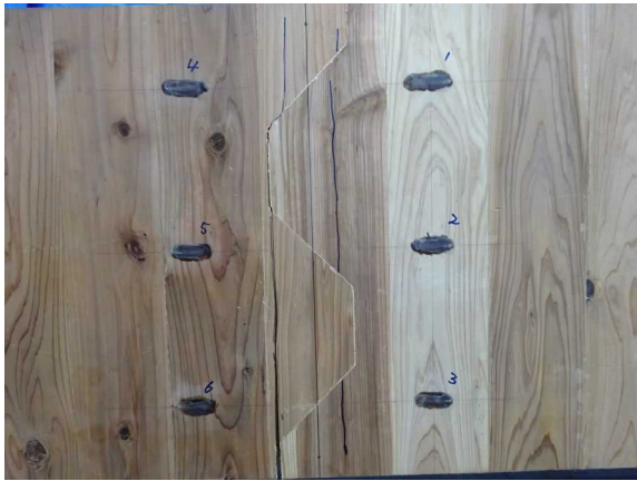
(e-3) 亀裂部分
