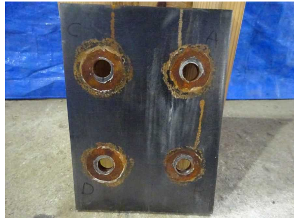
(c-20) ABCD側の鋼板 (裏) ※LSBが0.3mm程めり込んでいたと推測。
