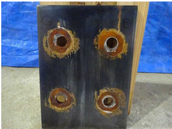
(c-21) EFGH側の鋼板 (裏) ※LSBが0.3mm程めり込んでいたと推測。
