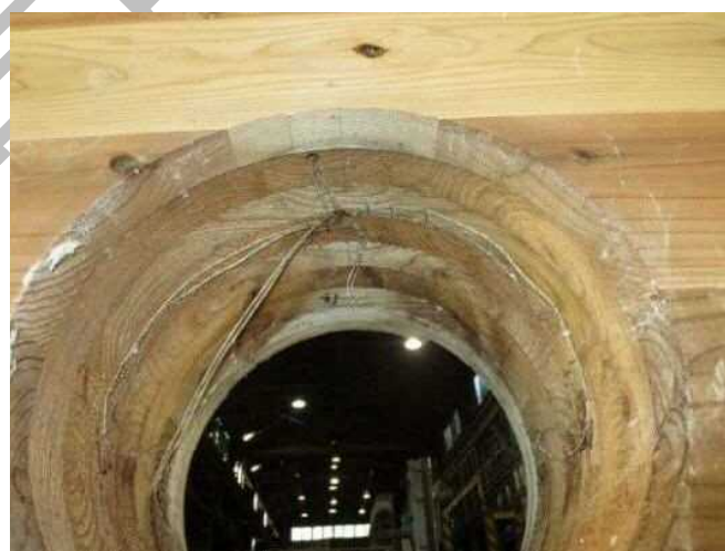
写真14 試験後の貫通孔（試験体B）の状況
