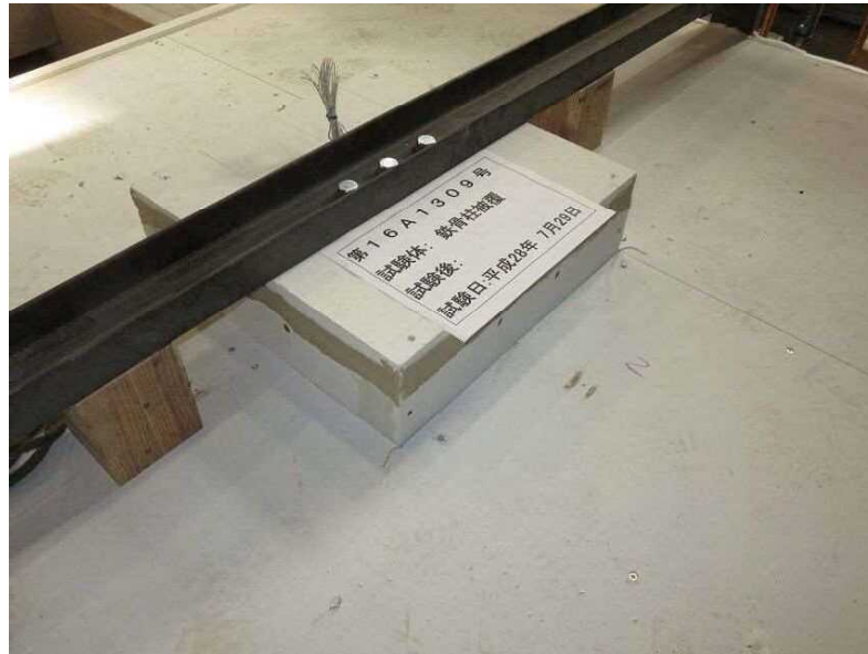
写真 18 試験後の試験体（裏面側）の状況
