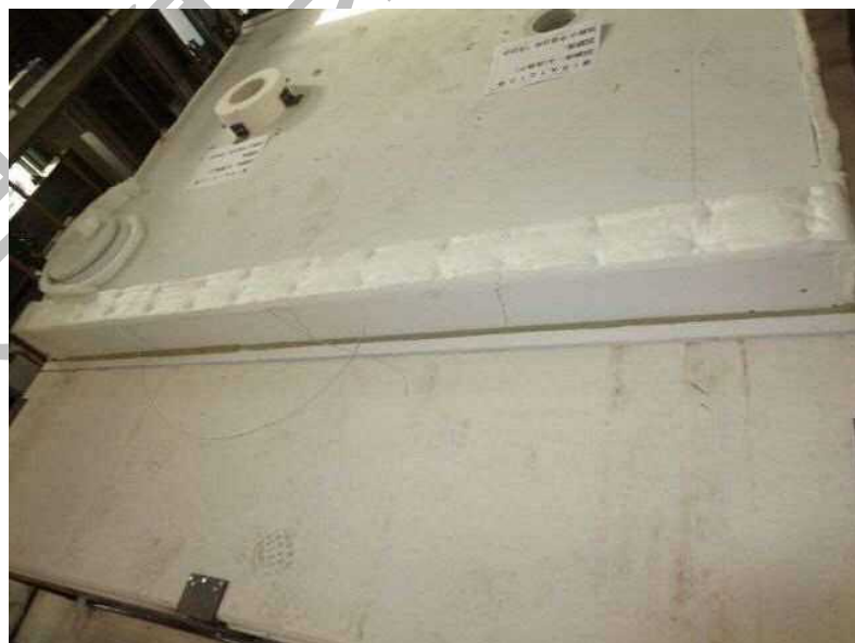
写真16 試験後の試験体（床取合い部：裏面側）の状況
