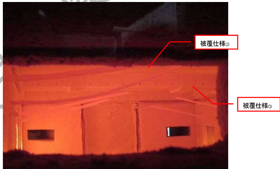
写真 17 試験開始 45 分時の試験体の状況（被覆仕様①及び②）
