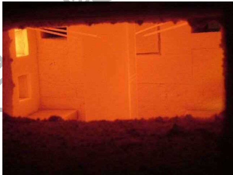
写真 11 試験開始 90 分時の試験体の状況
