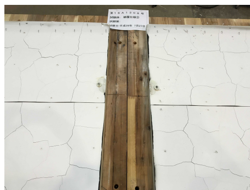
写真 4-6 被覆仕様③ 試験後 CLT 表面
