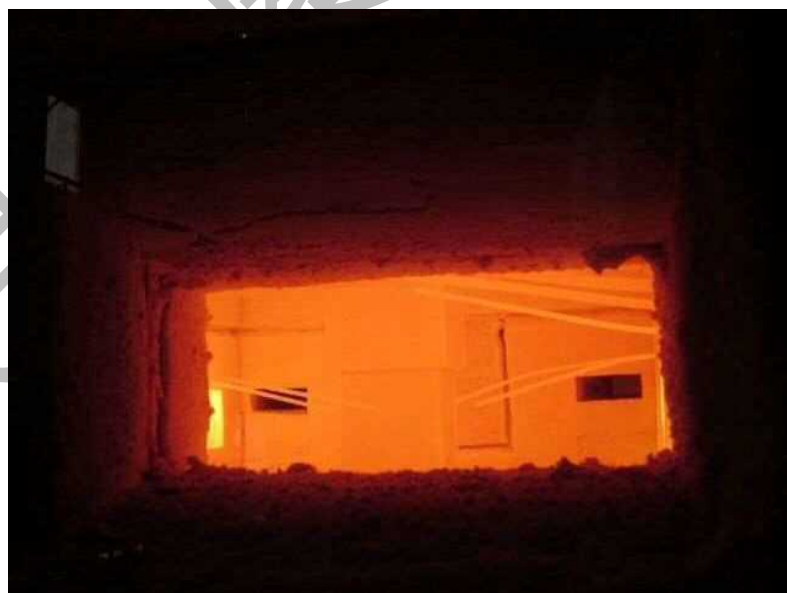
写真 13 試験開始 120 分時の試験体の状況
