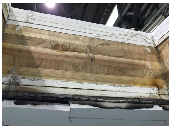
写真 3-1-1 加熱後 CLT 木口
