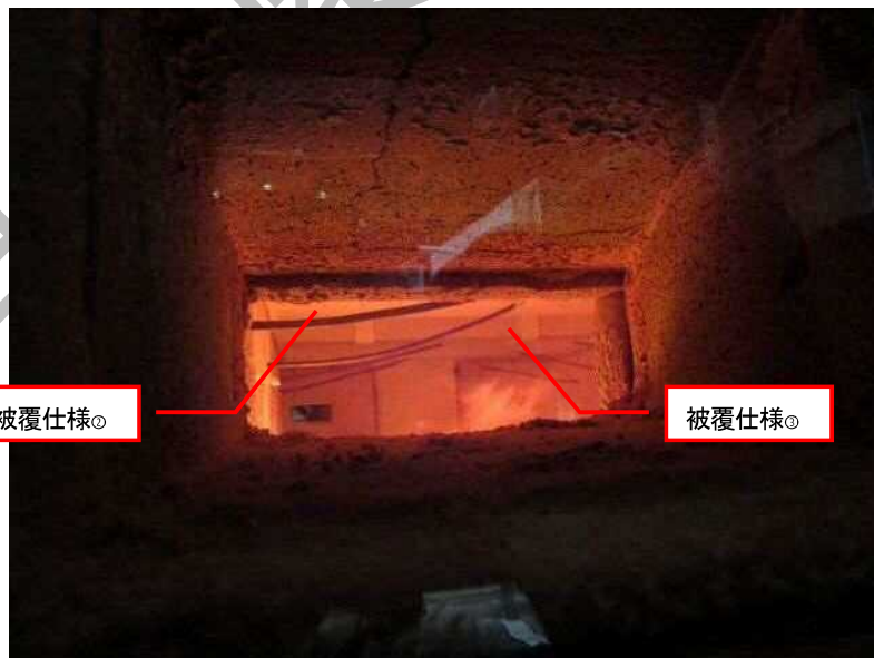
写真10 試験開始15分時の試験体の状況（被覆仕様◎及び◎）
