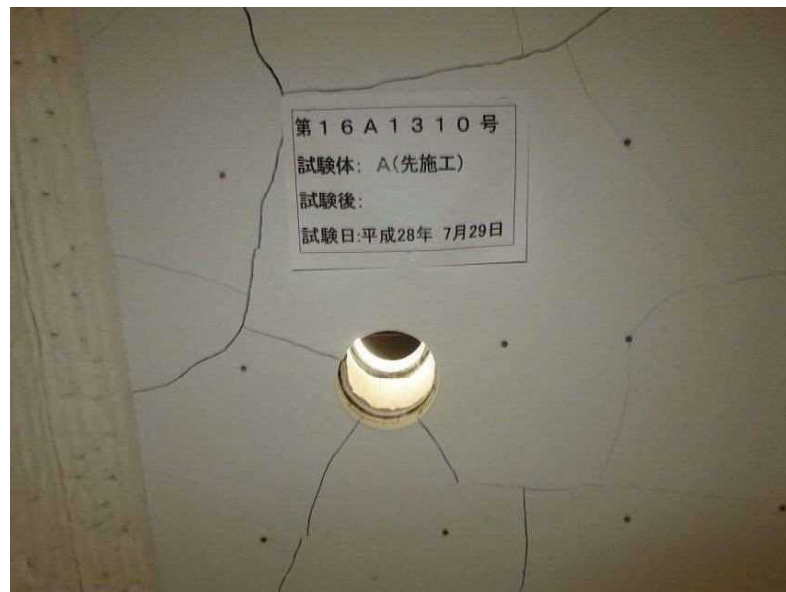
写真8 試験後の試験体（試験体A：加熱側）の状況
