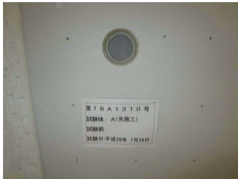
写真1 試験前の試験体（試験体A：加熱側）の状況
