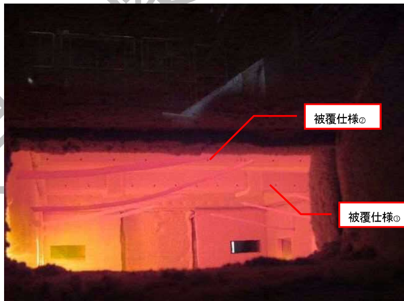
写真 14 試験開始 30 分時の試験体の状況（被覆仕様◎ 及び◎）
