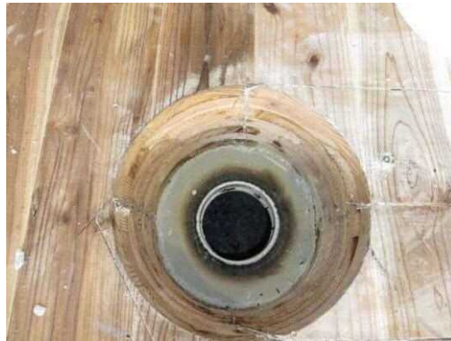
写真12 試験後の貫通孔（試験体A）の状況
