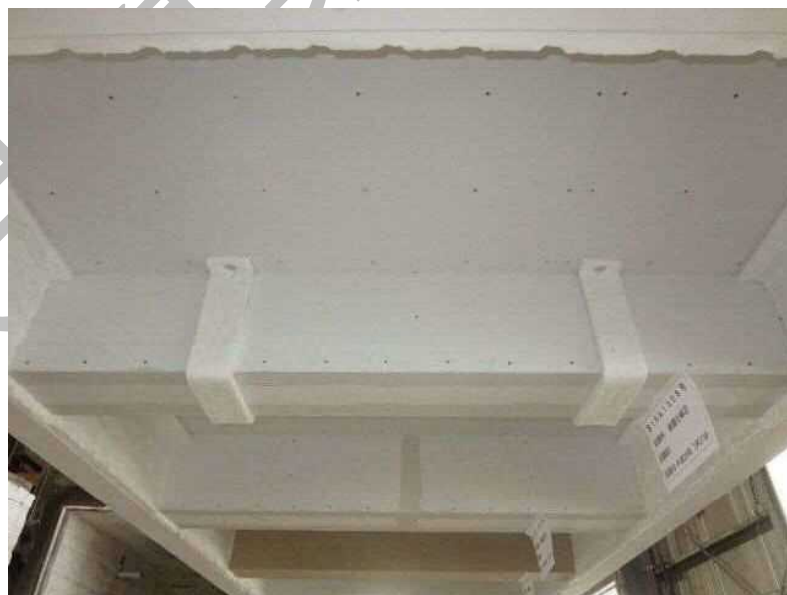
写真6 試験前の試験体（加熱側）の状況（被覆仕様◎）
