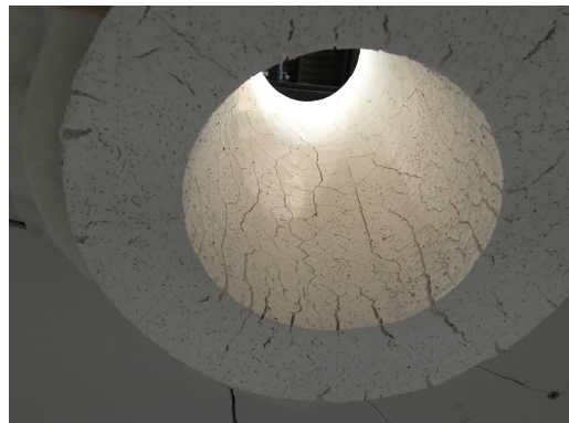
写真 2-2 石膏筒 加熱後
