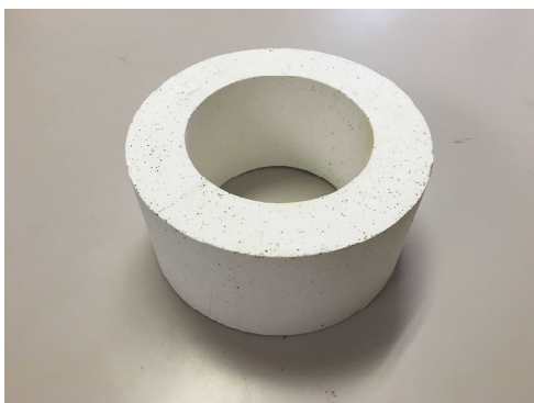
写真 2-1 石膏筒 加熱試験前
