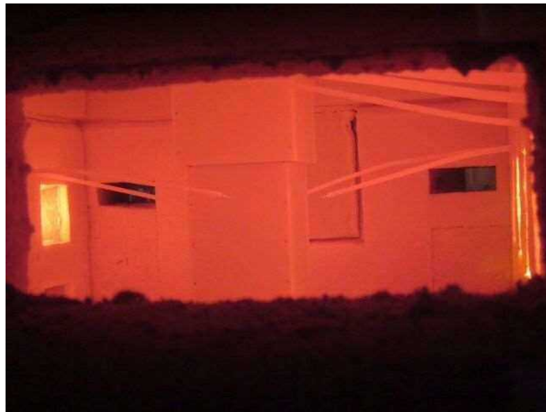
写真8 試験開始45分時の試験体の状況
