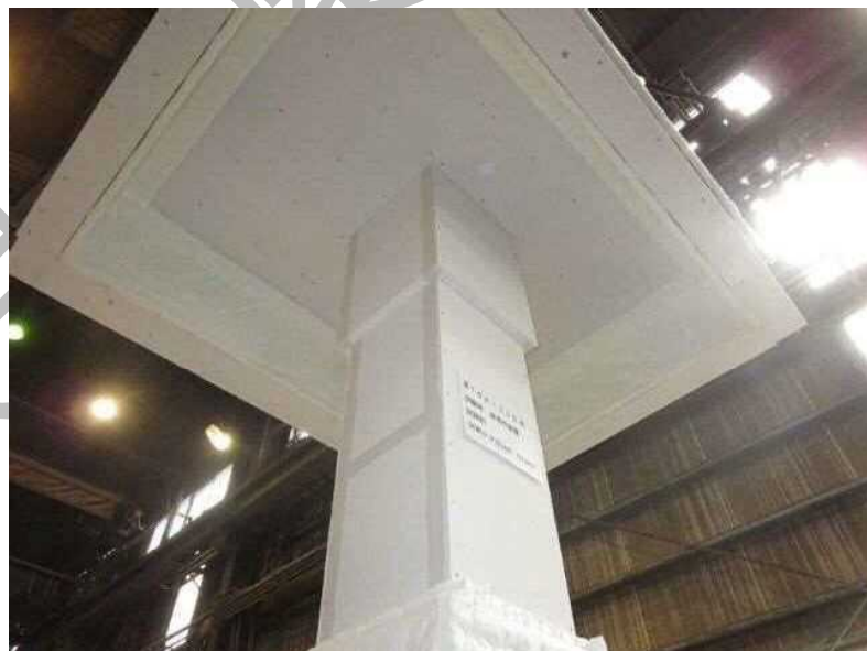
写真4 試験前の試験体（加熱側）の状況
