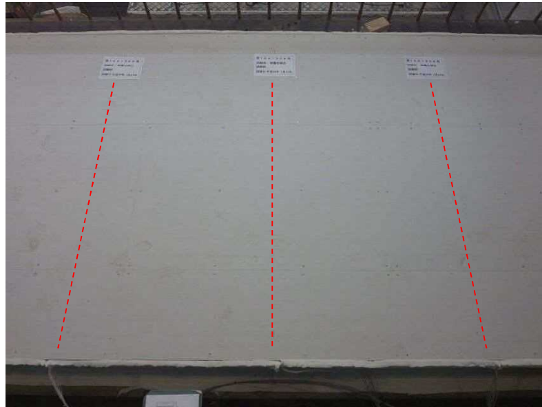
写真7 試験前の試験体（裏面側）の状況（左から被覆仕様①，②，③） （点線は，CLT パネル目地部を示す。）
