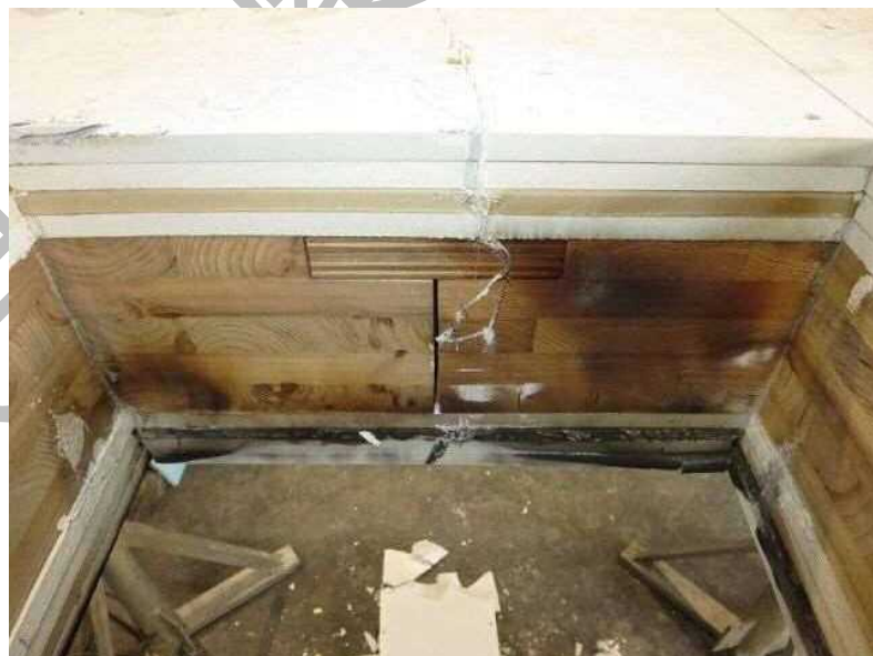
写真22 試験後の試験体（開口部：南）の状況
