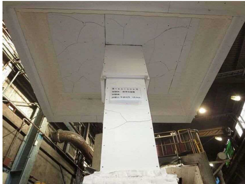
写真16 試験後の試験体（加熱側）の状況
