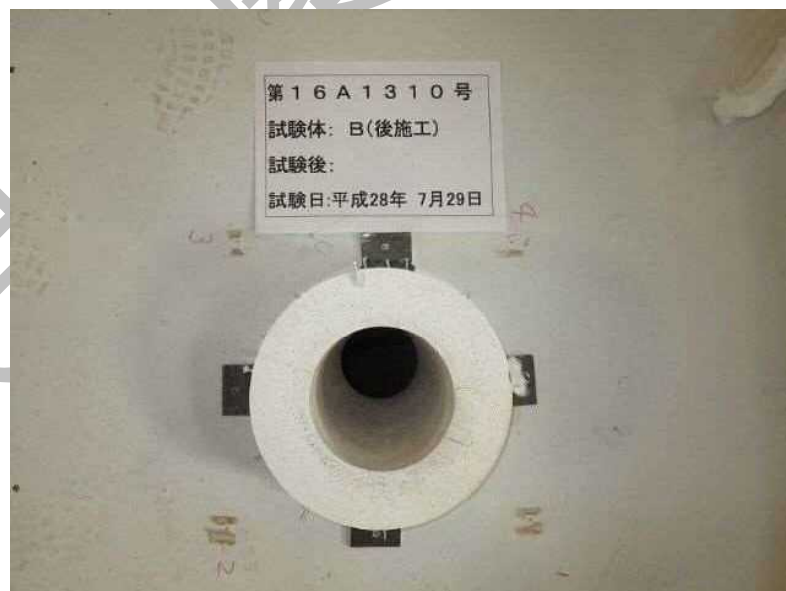
写真11 試験後の試験体（試験体B：裏面側）の状況
