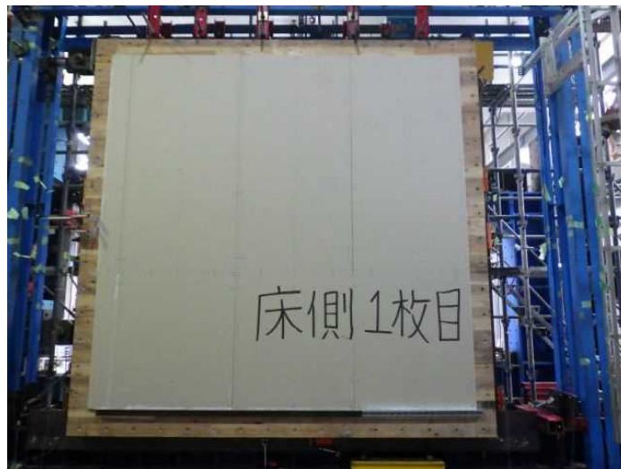
写真 3-2-8 床面 1 枚目・強化石膏ボード施工写真
