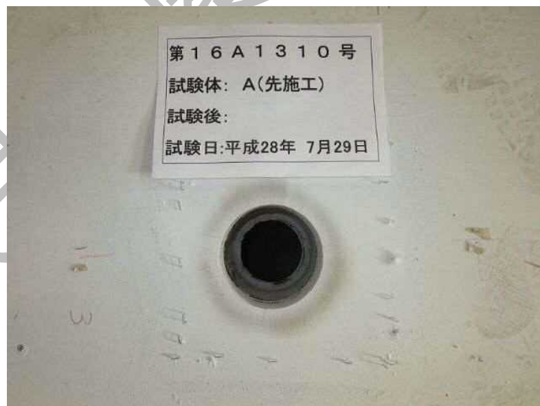
写真9 試験後の試験体（試験体A：裏面側）の状況
