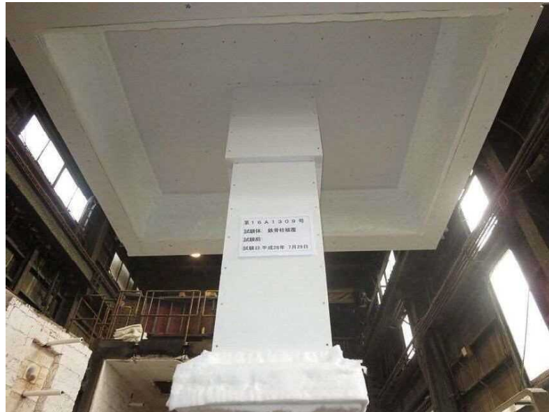
写真3 試験前の試験体（加熱側）の状況
