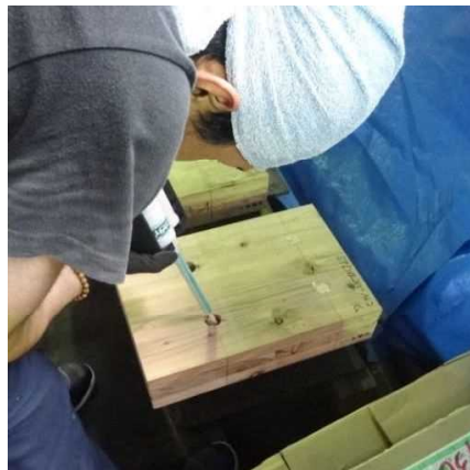
写真 1.1-2 エポキシ系接着剤充填風景
