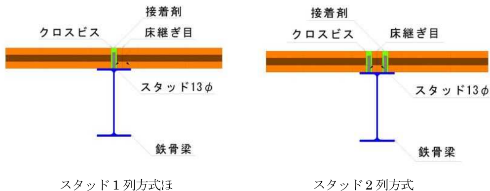
図 1.1-1 CLT 床と鉄骨梁の接合方法
