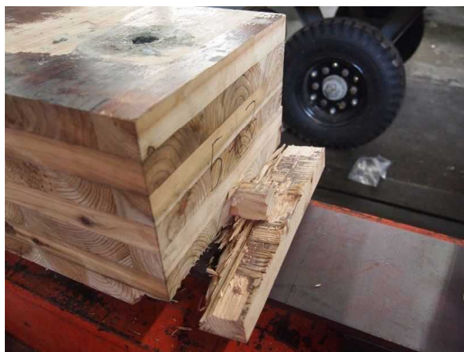
図 1.2.4-2.割裂による破壊(実験 A)
