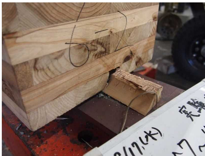
図 1.2.4-1.端抜けによる破壊(実験 A)
