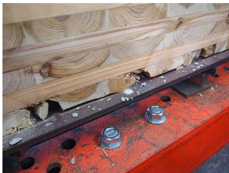
図 1.2.4-4.ローリングシアによる破壊(実験 B)
