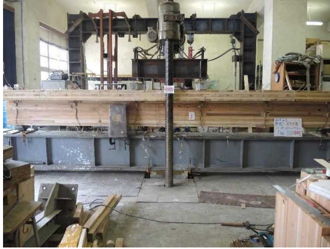
写真 4.3 一段筋試験体の加力前破壊状況
