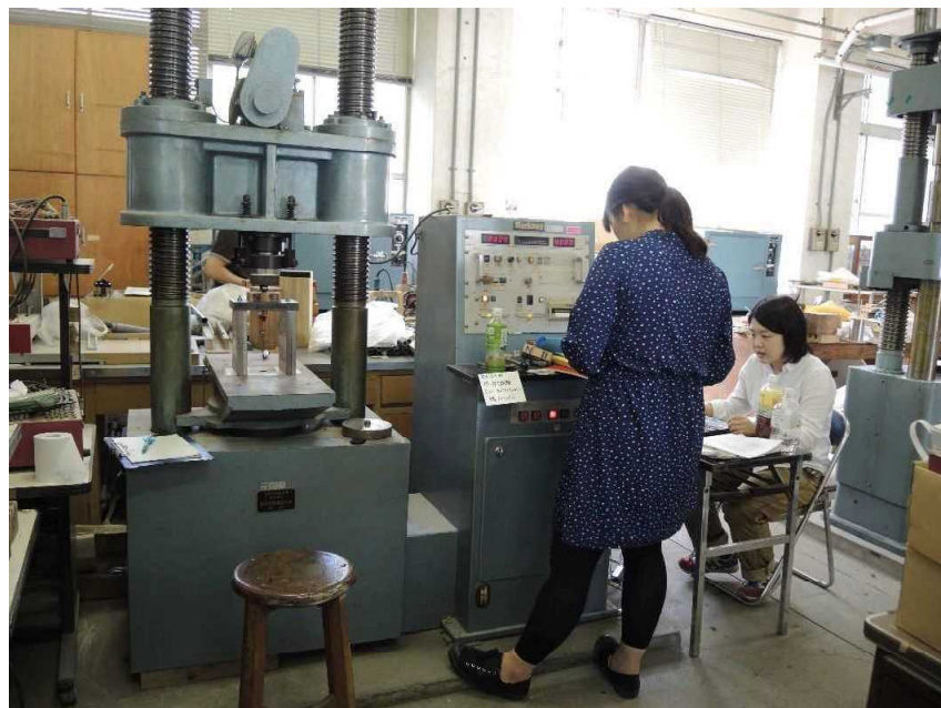
写真 3.1 鉄筋の押し抜き試験状況
