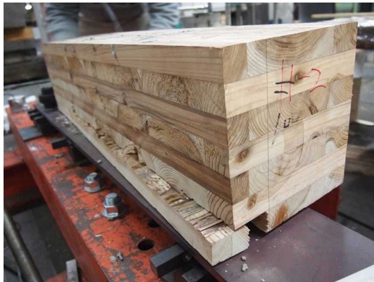
図 1.2.4-3.割裂による破壊(実験 B)
