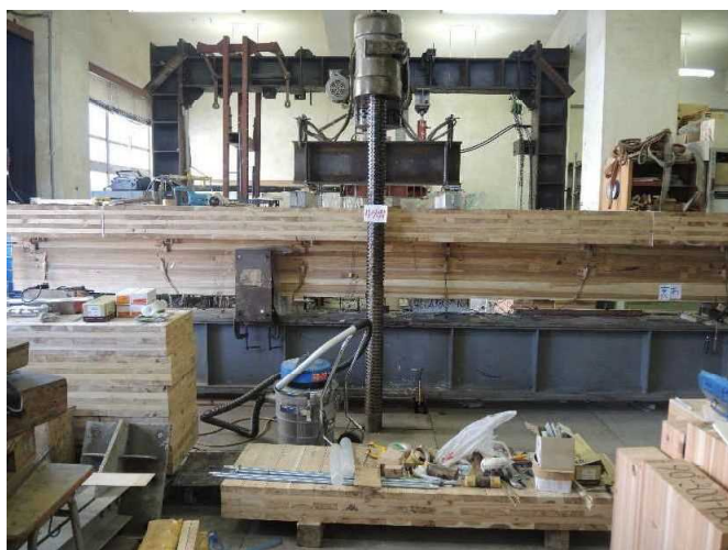
写真 4.8 二段筋試験体の破壊状況
