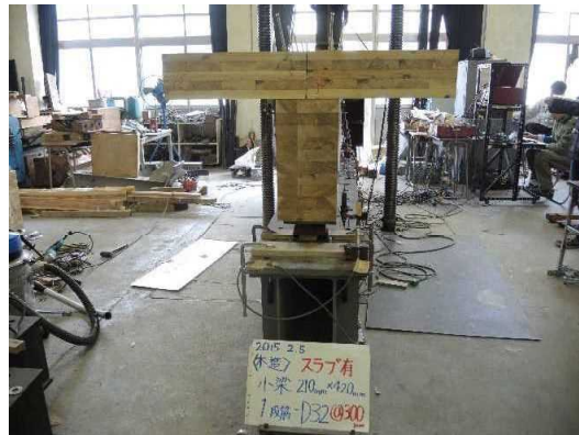
写真 4.4 一段筋試験体の加力前破壊状況
