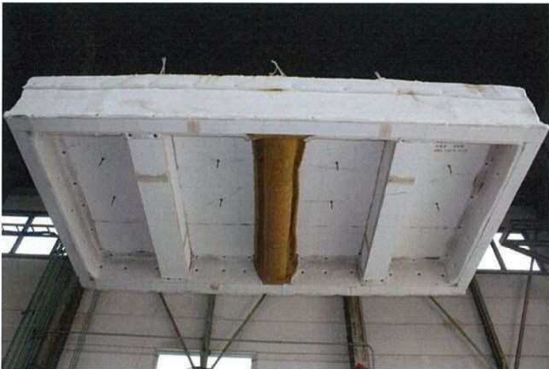
写真-2 試験後の加熱側の状況（試験体記号C）
