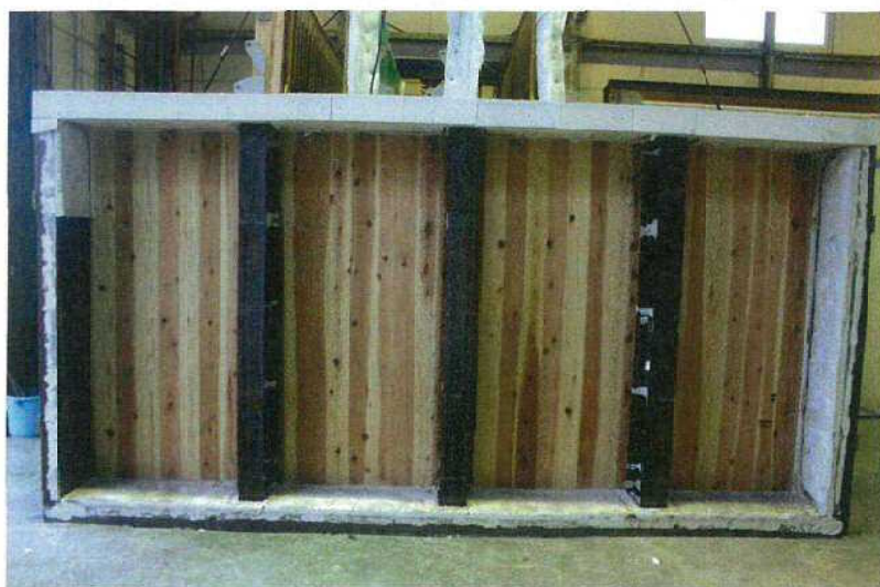
写真-9 試験後の加熱側 CLTパネル表面の状況
