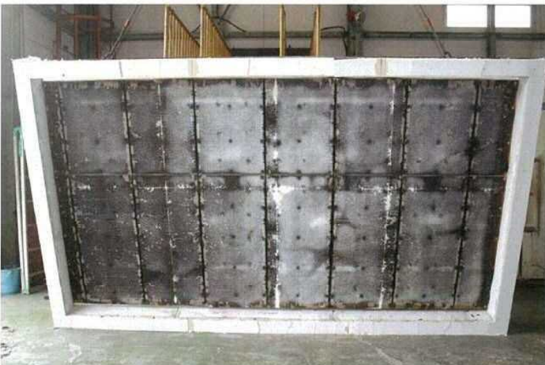
写真-6 試験後の加熱側（天井側） 上張強化せっこうボード 表面の状況 （試験体記号A）
