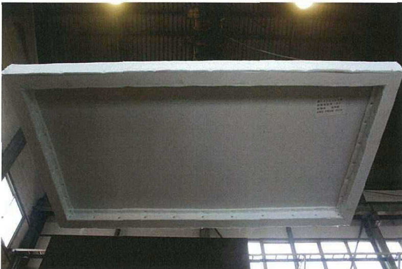
写真-11 試験前の加熱側（天井側） の状況（試験体記号A2）
