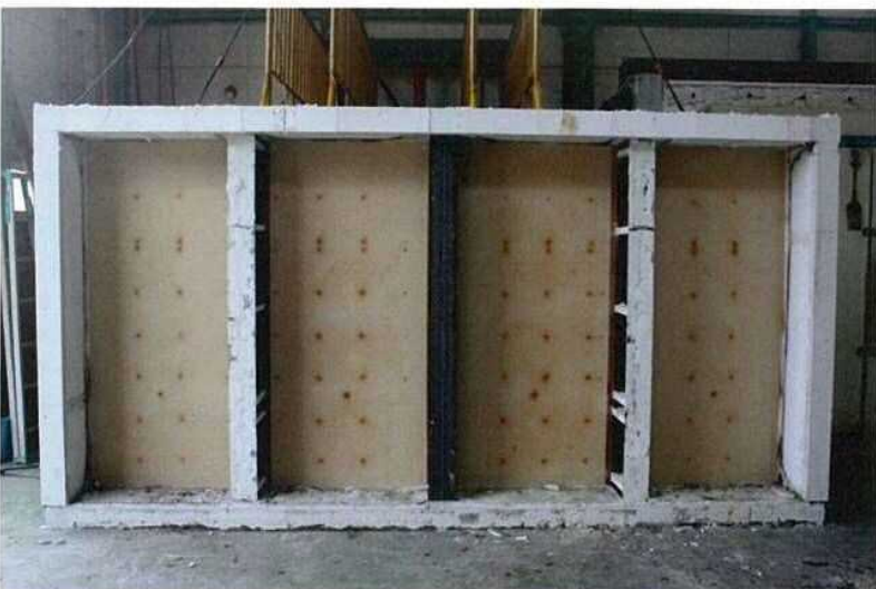
写真-6 試験後の加熱側 下張強化せっこうボード の状況（試験体記号C）
