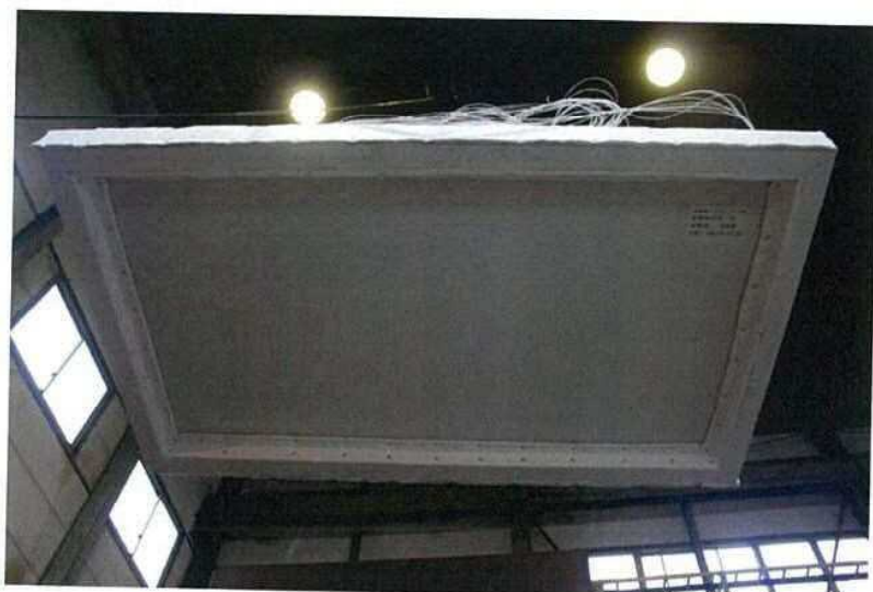
写真-2 試験前の加熱側（天井側） の状況（試験体記号B）
