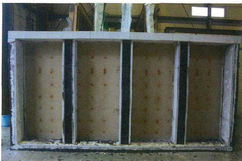
写真-8 試験後の加熱側 下張強化せっこうボード の状況
