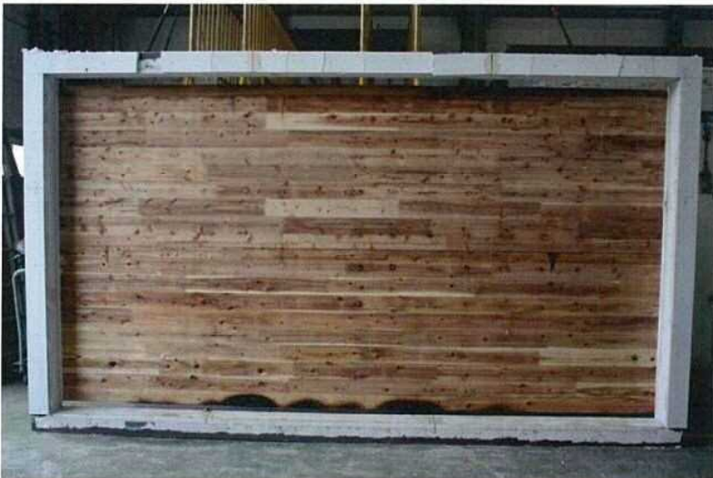
写真-8 試験後の加熱側（天井側） CLTパネル表面の状況 （試験体記号A）
