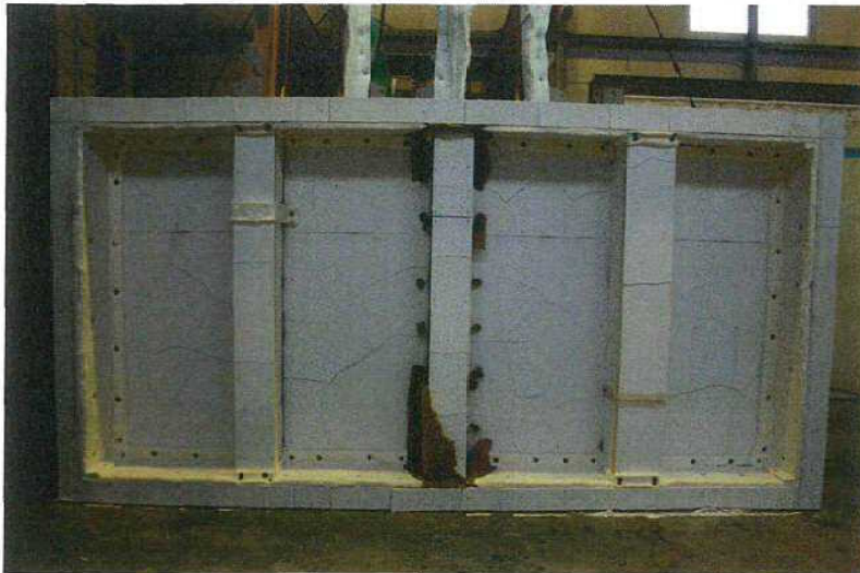
写真-5 試験後の加熱側 けい酸カルシウム板 の状況
