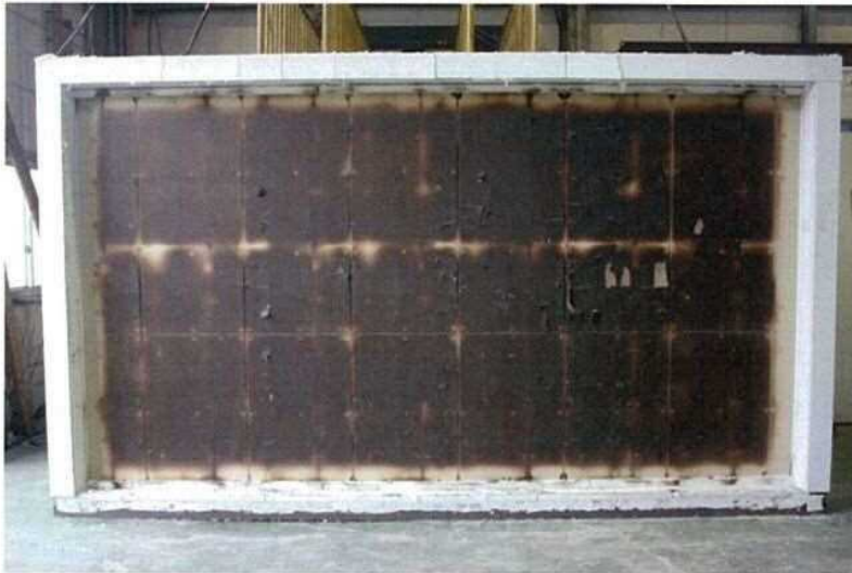
写真-7 試験後の加熱側（天井側） 下張強化せっこうボード 表面の状況 （試験体記号B）
