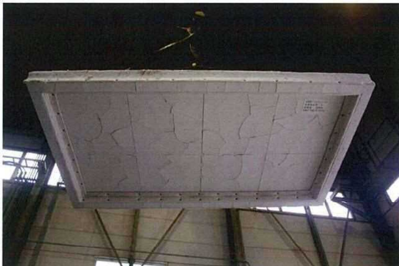
写真-4 試験後の加熱側（天井側） の状況（試験体記号B）
