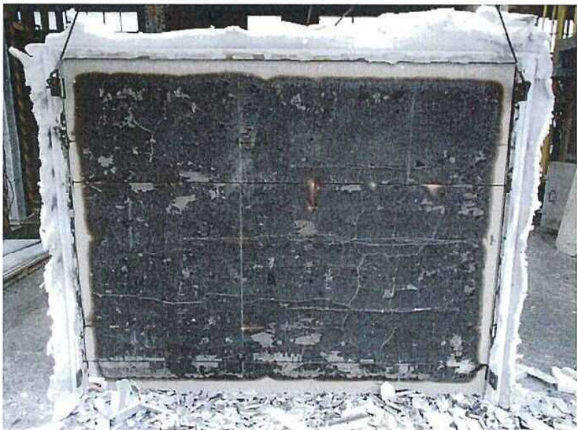
写真-13 試験後の中張強化せっこうボード 表面の状況（床側）（試験体記号B）
