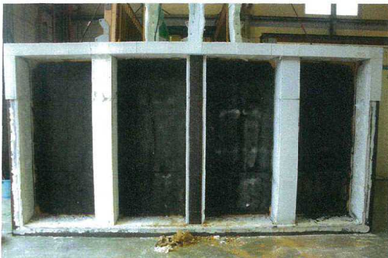
写真-6 試験後の加熱側 上張強化せっこうボード の状況
