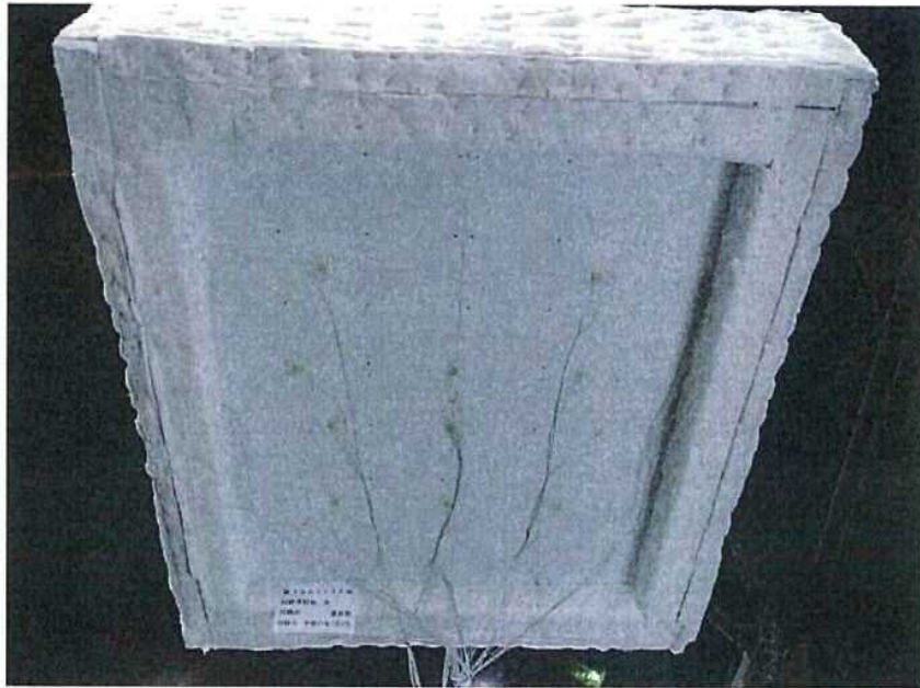
写真-9 試験前の裏面側（天井側）の状況（試験体記号B）
