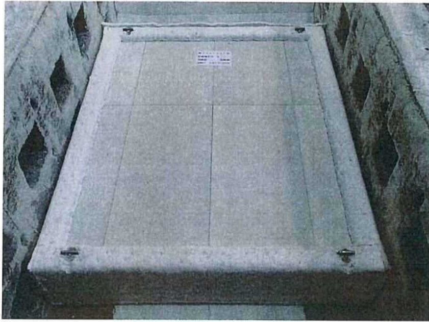
写真-1 試験前の加熱側（床側）の状況（試験体記号A）
