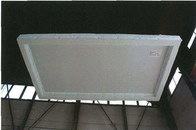
写真-2 試験前の加熱側（天井側） の状況（試験体記号A1）
