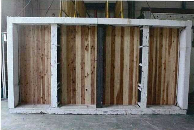
写真-7 試験後の加熱側 CLTパネル表面の状況 (試験体記号C)
