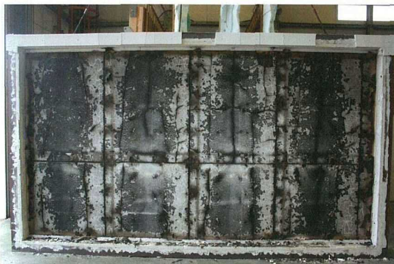
写真-15 試験後の加熱側（天井側） 上張強化せっこうボード 表面の状況 （試験体記号A2）
