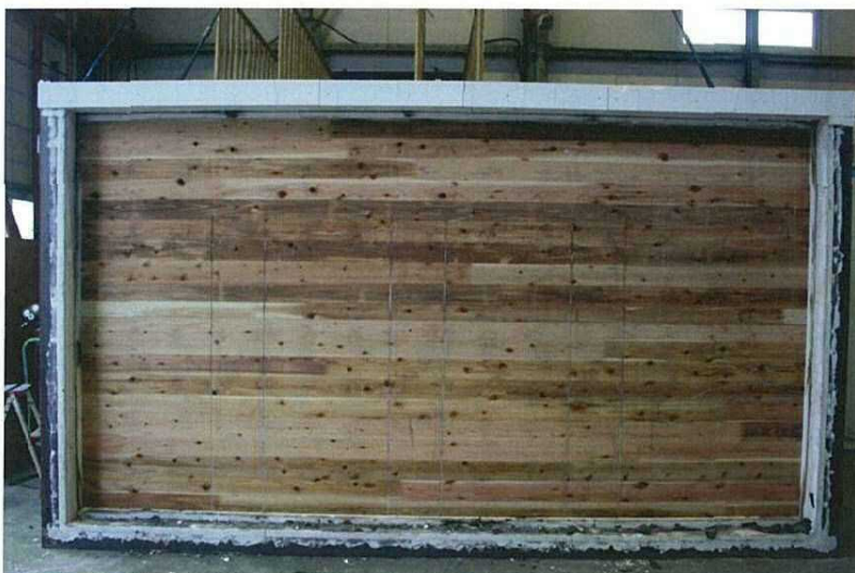
写真-9 試験後の加熱側（天井側） CLTパネル表面の状況 （試験体記号A1）
