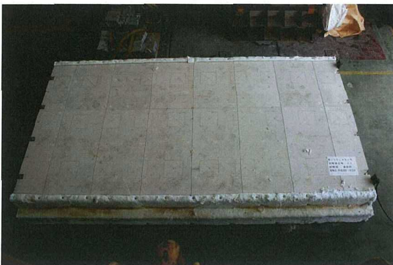
写真-3 試験後の裏面側（床側） の状況（試験体記号A1）
