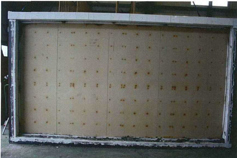
写真-8 試験後の加熱側（天井側） 下張強化せっこうボード 表面の状況 （試験体記号A1）
