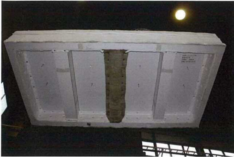
写真-1 試験前の加熱側の状況（試験体記号C）
