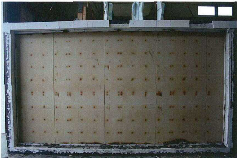
写真-17 試験後の加熱側(天井側) 下張強化せっこうボード 表面の状況 (試験体記号A2)
