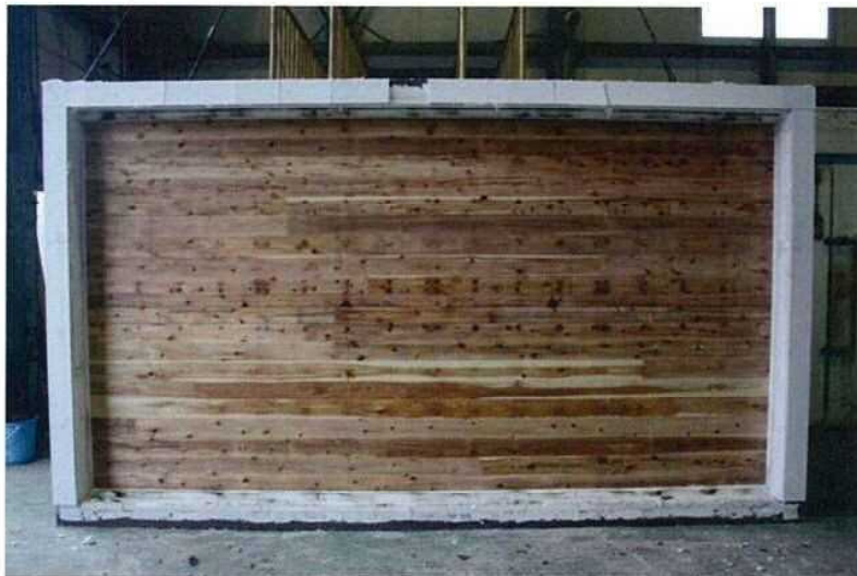
写真-8 試験後の加熱側（天井側） CLTパネル表面の状況 （試験体記号B）
