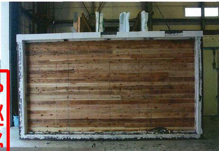
写真-18 試験後の加熱側(天井側) CLTパネル表面の状況 (試験体記号A2)
