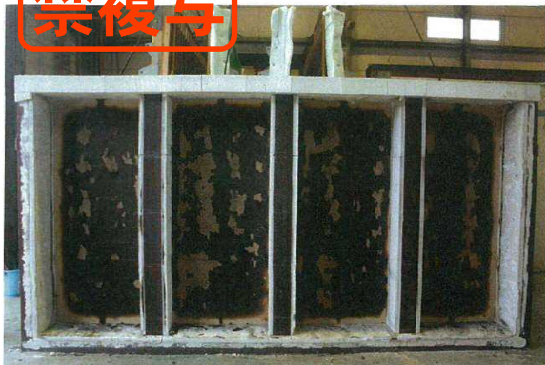
写真-7 試験後の加熱側 中張強化せっこうボード の状況
