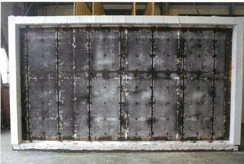
写真-6 試験後の加熱側（天井側） 上張強化せっこうボード 表面の状況 （試験体記号B）
