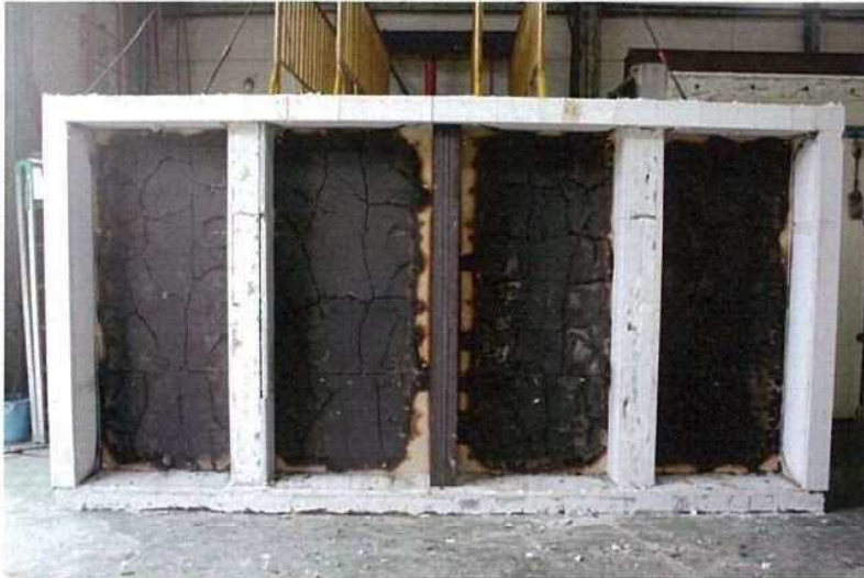
写真-4 試験後の加熱側 上張強化せっこうボード の状況（試験体記号C）
