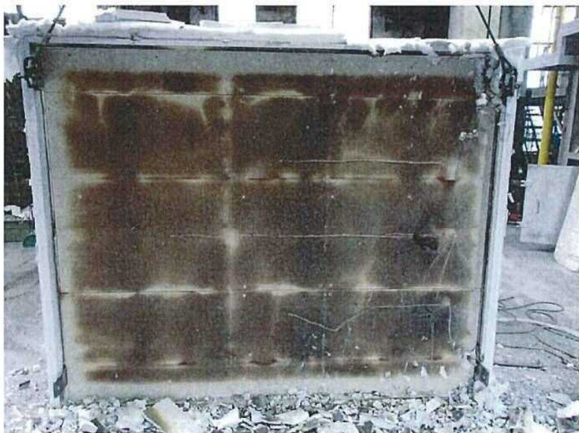
写真-6 試験後の下張強化せっこうボード 表面の状況（床側）（試験体記号A）
