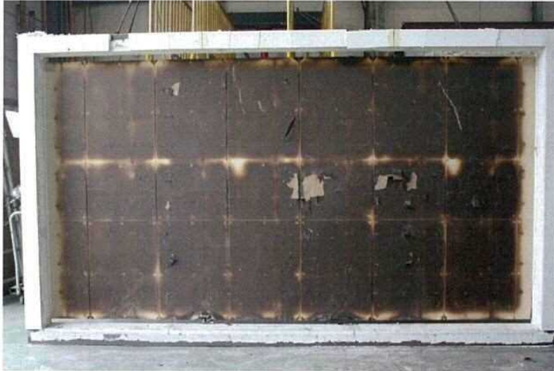
写真-7 試験後の加熱側（天井側） 下張強化せっこうボード 表面の状況 （試験体記号A）
