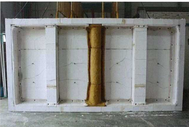
写真-3 試験後の加熱側けい酸カルシウム板の状況（試験体記号C）
