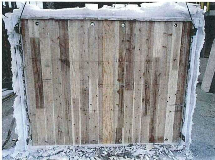
写真-15 試験後のCLTパネル 表面の状況（床側）（試験体記号B）
