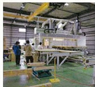
プレカット工場、パネルサイズと金物の取付け部分や接合部を加工。
